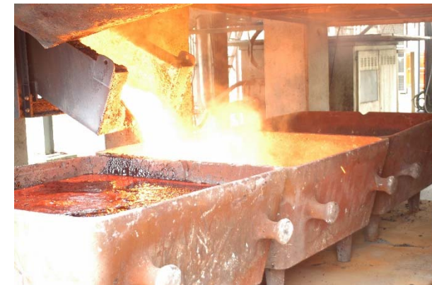
Sortie de four Inertam - Déchets d'amiante en fusion
